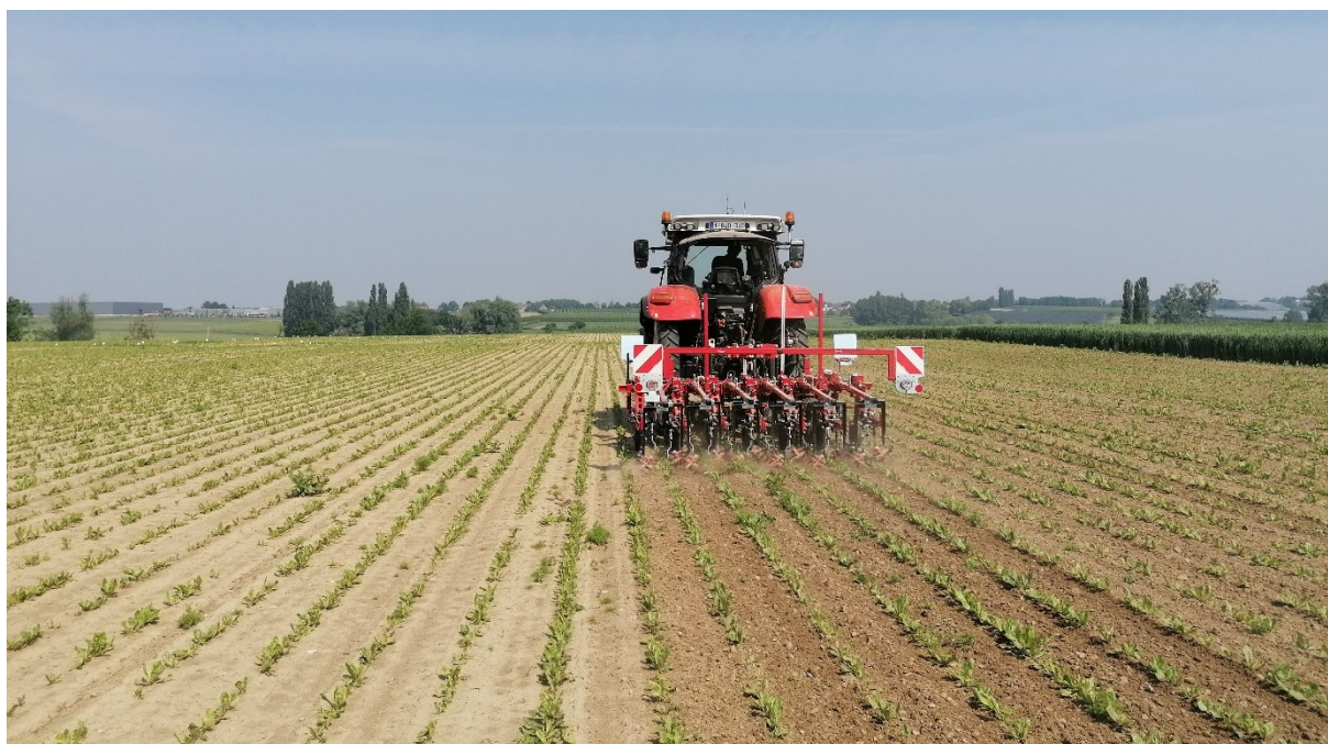
Figuur 13. Steketee cameragestuurde schoffel met kantmessen en vingerwieders.
