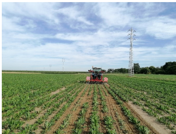
Figuur 19. Mechanische passage met de wiedegegens; door deze passage werd de korst op de bodem gebroken.
