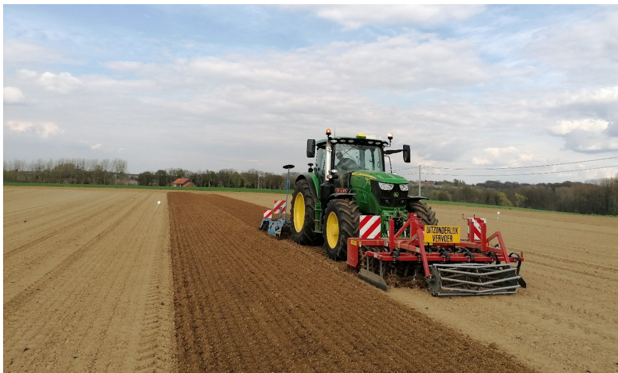
Figuur 34. Vals zaaibed aangelegd met rotoeg – croskilette, en vlak voor de zaai opnieuw bewerkt met dezelfde combinatie. Het vals zaaibed hield het bodemvocht mooi vast. Foto 14 april 2022.
