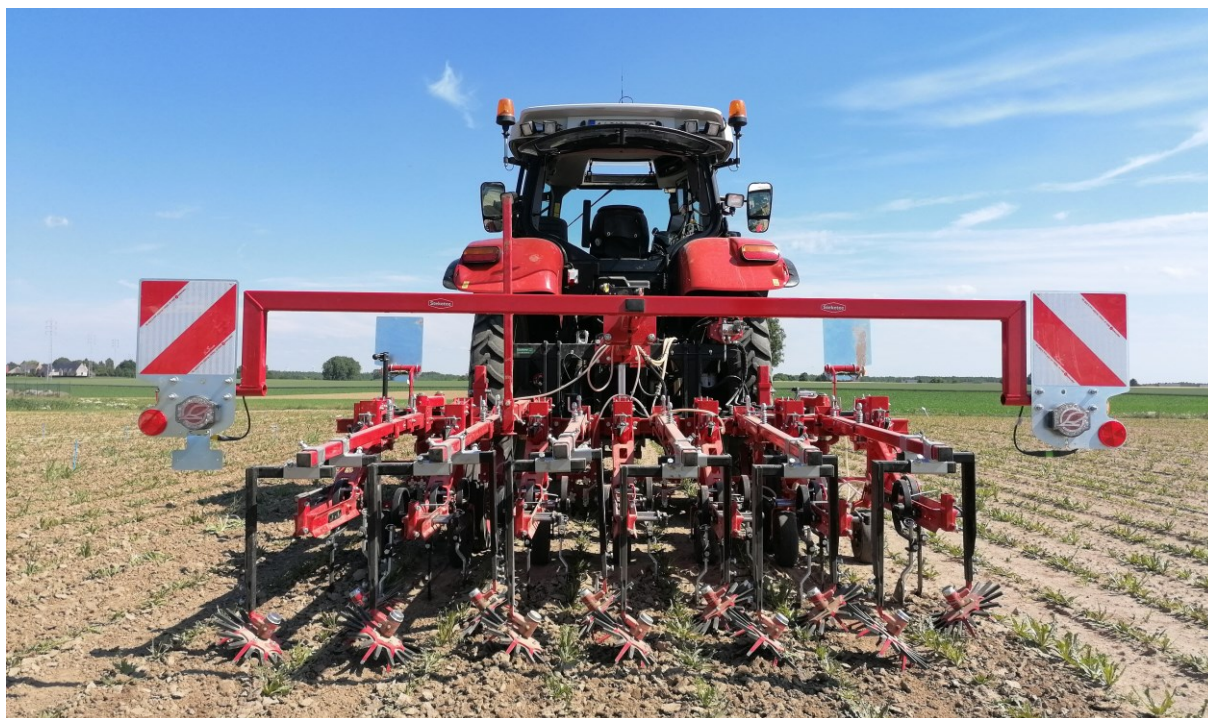
Figuur 17. Schoffel uitgerust met ganzenvoet, kantmessen en vingerwieders. De korst op de verslechte bodem werd opnieuw gebroken.
