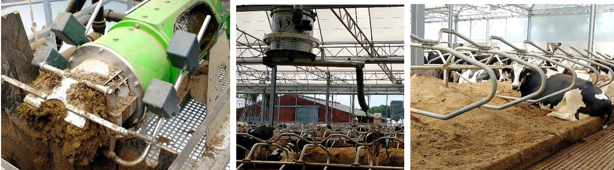
Figuur 2: Vijzelpers (links), automatische toediening van dikke fractie (midden), dikke fractie in ligboxen (rechts).
