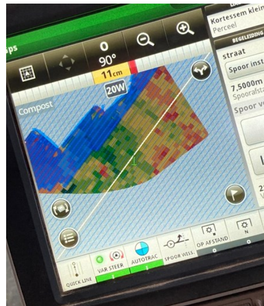
Figuur 6 Schermafbeelding van de taakkaart op de GPS in de tractor (proefperceel 2). De kleuren variëren van rood (lage dosis compost) tot groen (hoge dosis compost). De blauwe kleur geeft aan waar er reeds compost werd gestrooid.
