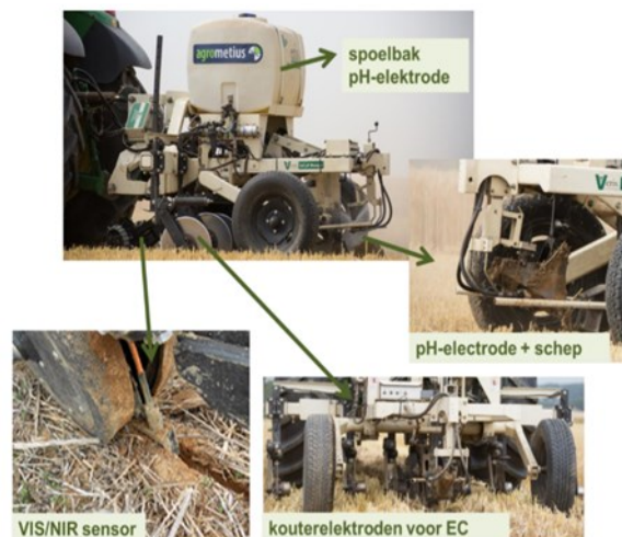
Figuur 1 Opbouw van de Veris MSP3 bodemscanner (Dillen et al., 2019)
