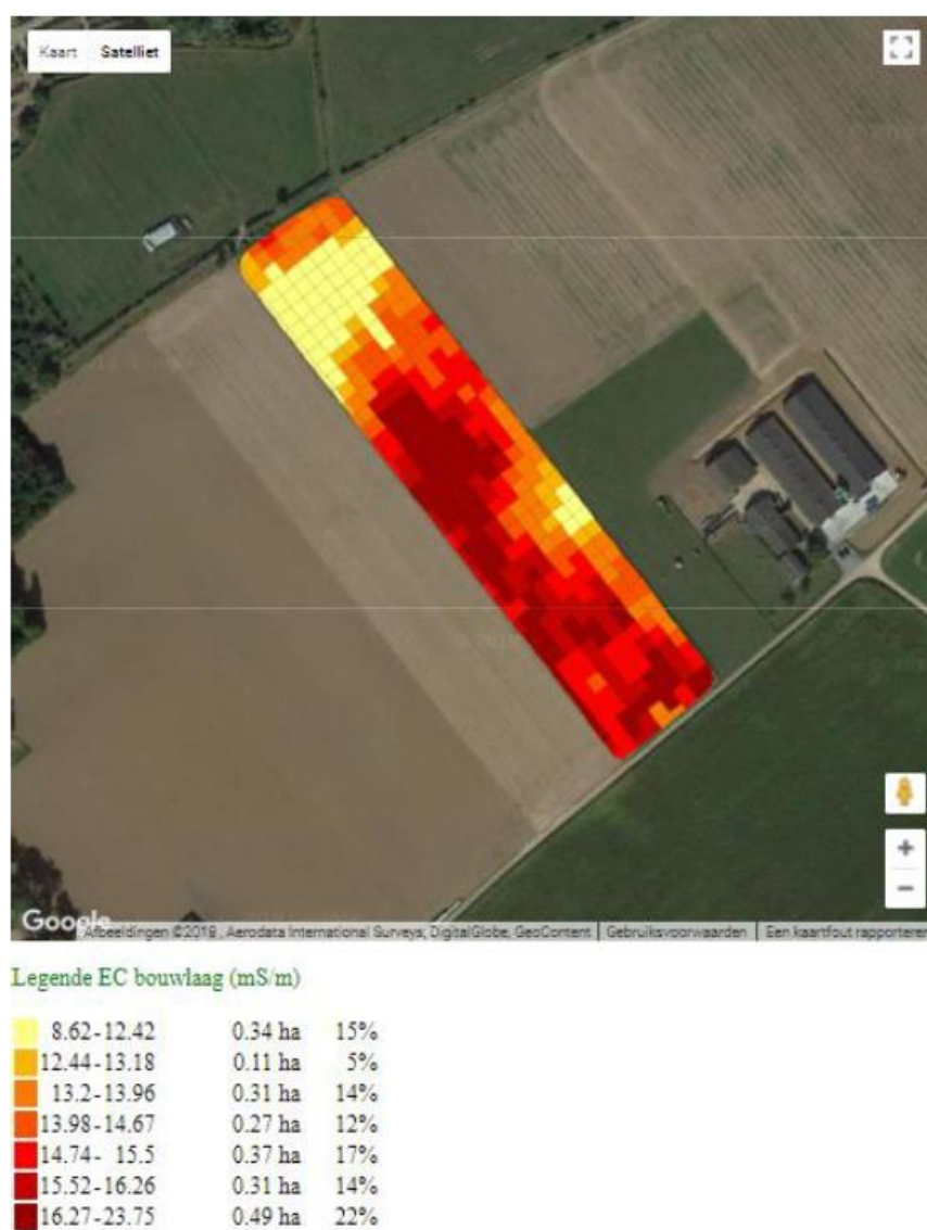
Figuur 32. Perceel 5, elektrische geleidbaarheid (EC) van de bodem in de laag 0 – 30 cm, bepaald op 23 maart 2018. Plotgrootte 8 m * 8 m.
