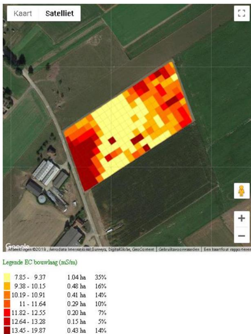
Figuur 31. Perceel 4, elektrische geleidbaarheid (EC) van de bodem in de laag 0 – 30 cm, bepaald op 13 augustus 2018. Plotgrootte 12 m * 12 m.
