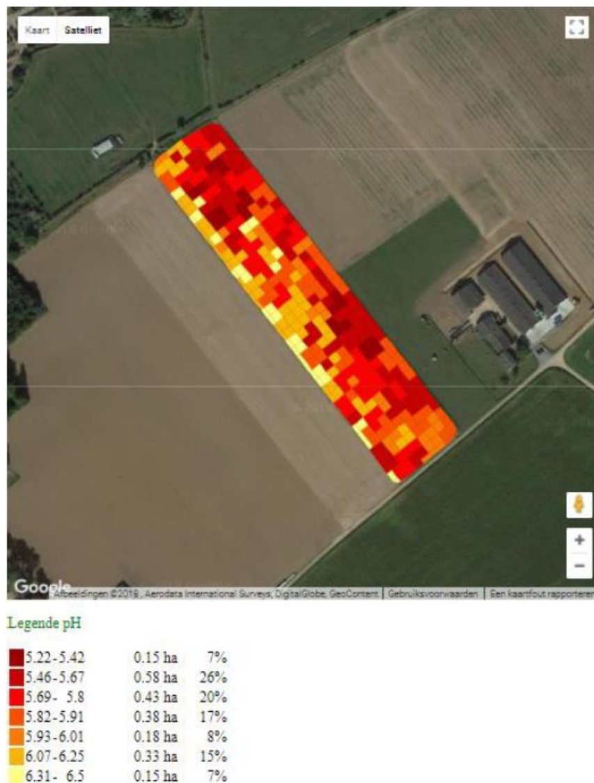
Figuur 4. pH-kaart perceel 5, bepaald met de Veris MSP3 bodemscan op 23 maart 2018 (vlak voor de zaai van suikerbieten). Plotgrootte 8 m * 8 m.
