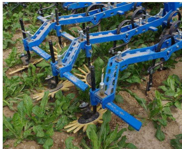
Vingerwieders: werking in rij. Vegen onkruid weg. Stadium onkruid: max 2-blad Stadium biet: min 4-6 blad
