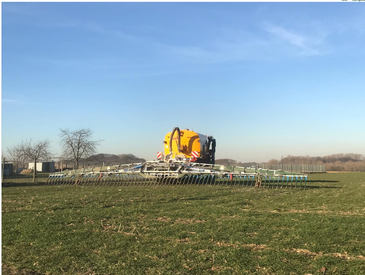
Figuur 2 Sleepvoetbemester (werkbreedte 18 m) bevestigd achter zelfrijdende mestinjecteur (loonbedrijf Vanvinckenroye BVBA). De sleepvoetbemester maakt insnijdingen van 2 – 3 cm diep. De afstand tussen de insnijdingen bedraagt 25 cm.
