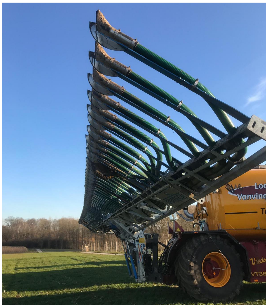
Figuur 1 Sleepvoetbemester achter zelfrijdende mestinjecteur.
