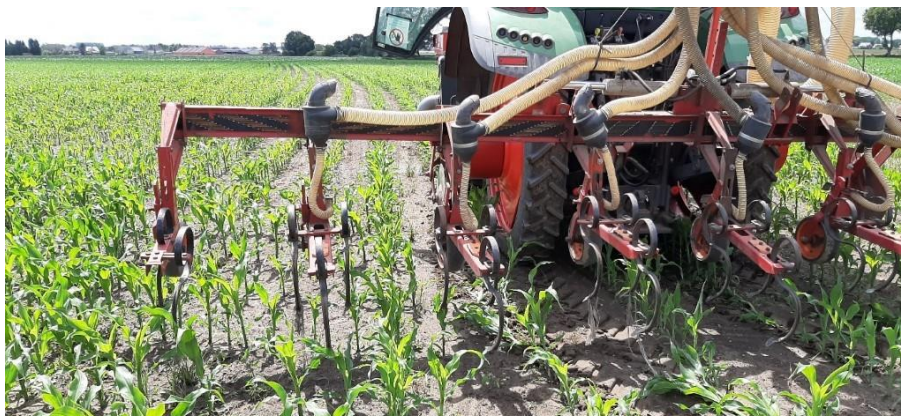
Figuur 17 Onderzaaimachine zelfbouw schoffel Noord-Limburg
