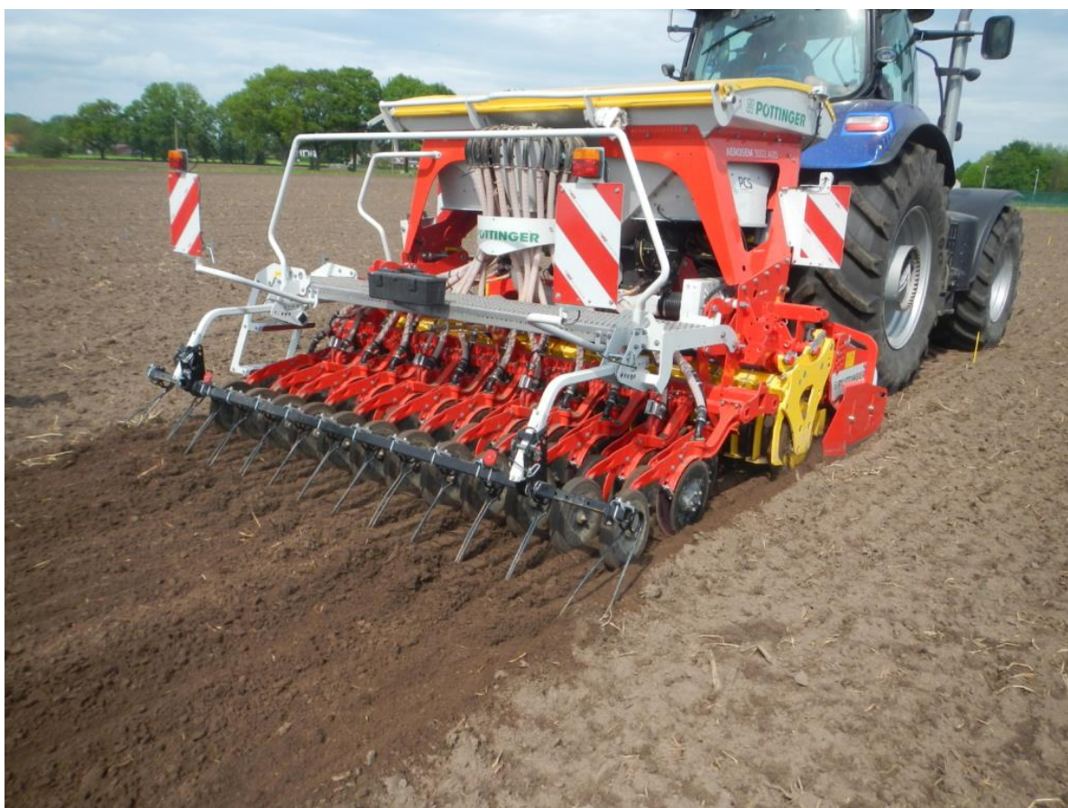
Figuur 11 Gelijktijdige inzaai van maïs en gras door combinatiezaaimachine van Pöttinger (Bron: LCV)
