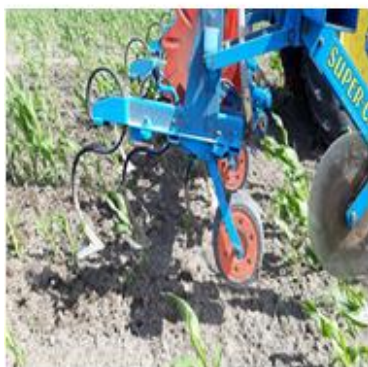
Figuur 13 Schoffels en wiedegeen waarop een zaadbak is gebouwd
