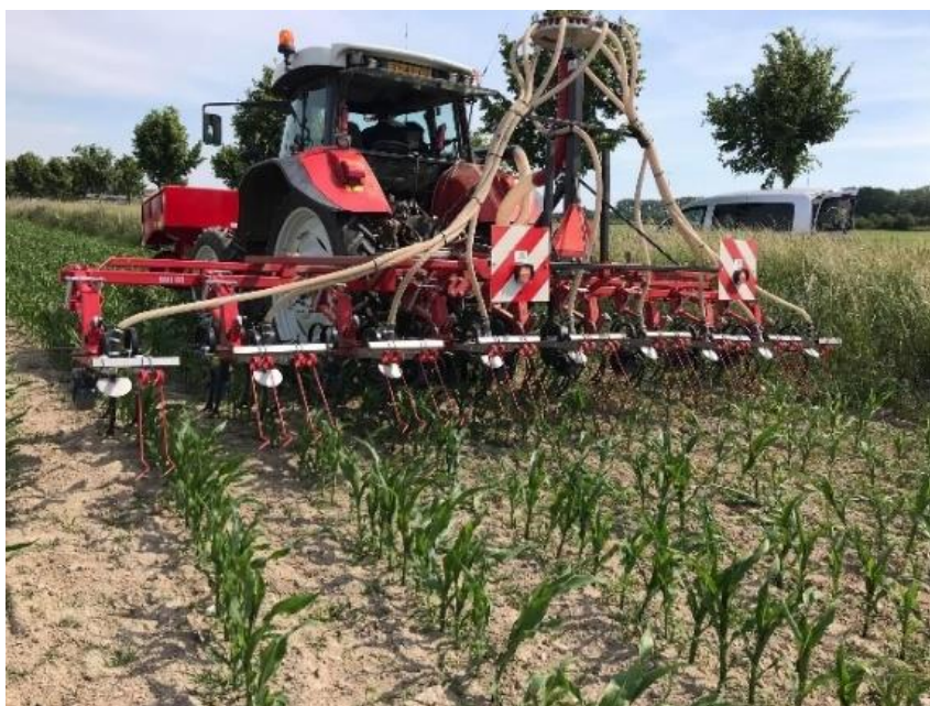
Figuur 16 Onderzaaimachine zelfbouw Zuid-Limburg.
