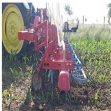
Figuur 13 Schoffels en wiedegeen waarop een zaadbak is gebouwd
