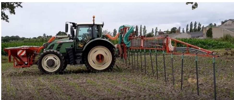
Figuur 15 Onderzaaimachine zelfbouw spuitmachine
