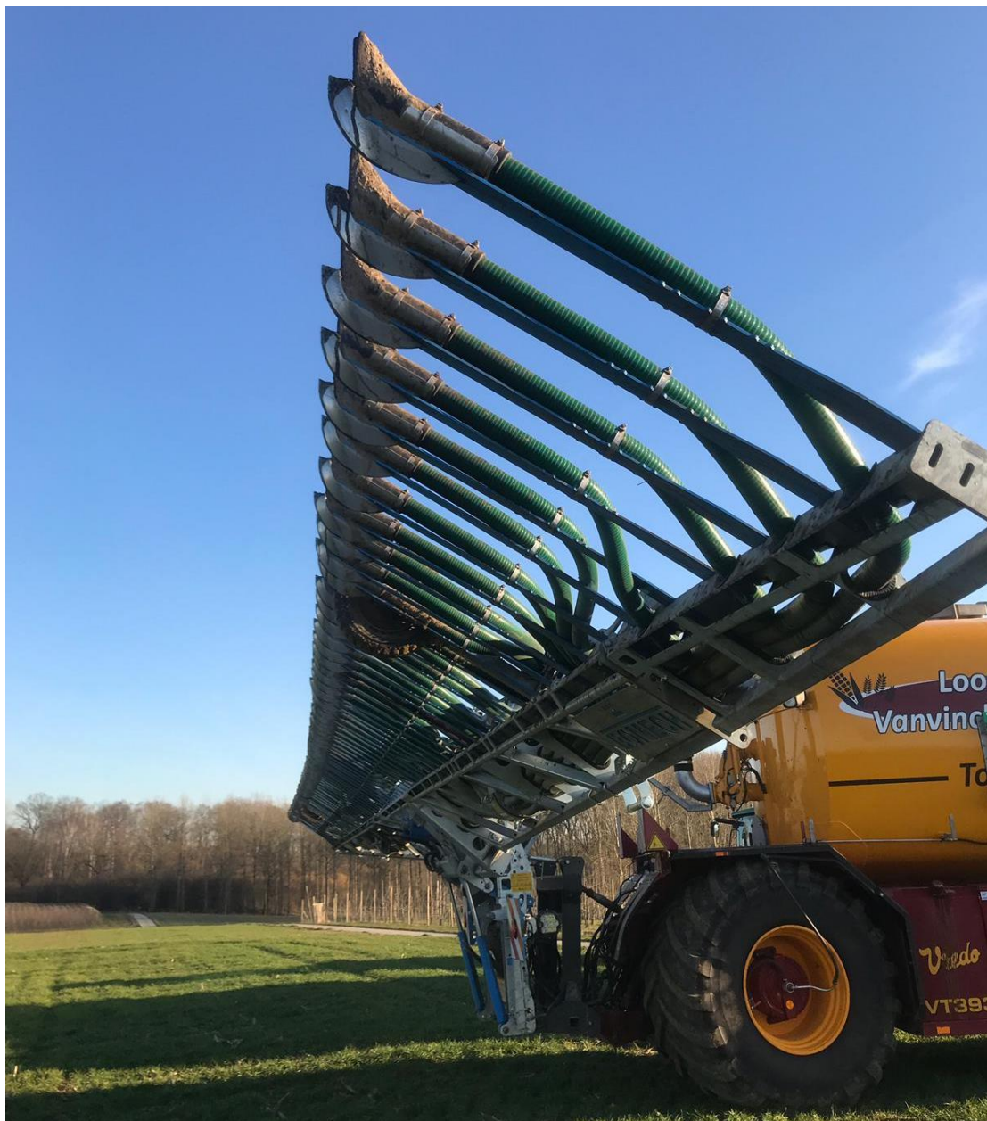
Figuur 8 Sleepvoetbemester achter zelfrijdende mestinjecteur.
