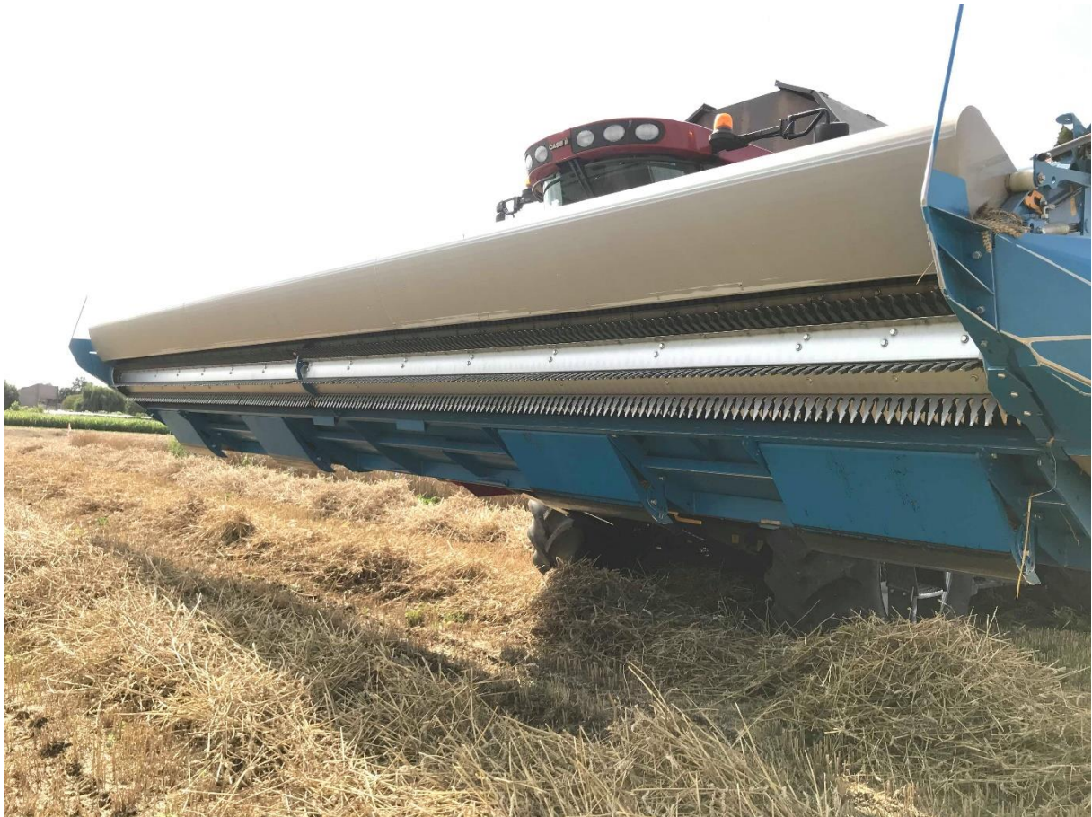
Figuur 20. Roterende vingers in de bek van de arenstripper. De vingers roteren, in het perspectief van de foto, in wijzerzin en strippen de aar van onder naar boven.
