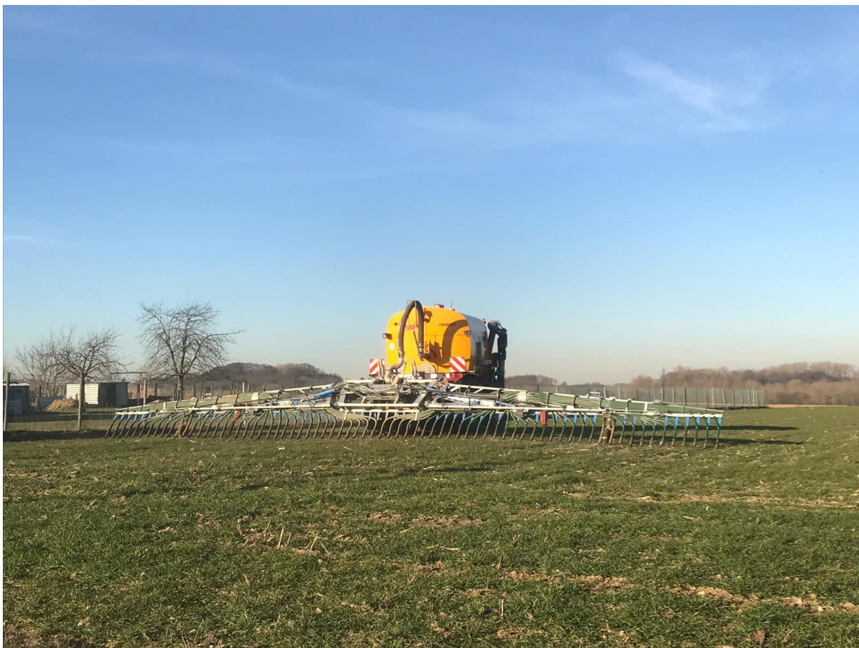
Figuur 9 Sleepvoetbemester (werkbreedte 18 m) bevestigd achter een zelfrijdende mestinjecteur (loonbedrijf Vanvinckenroye BVBA). De sleepvoetbemester maakt insnijdingen van 2 – 3 cm diep. De afstand tussen de insnijdingen bedraagt 25 cm.
