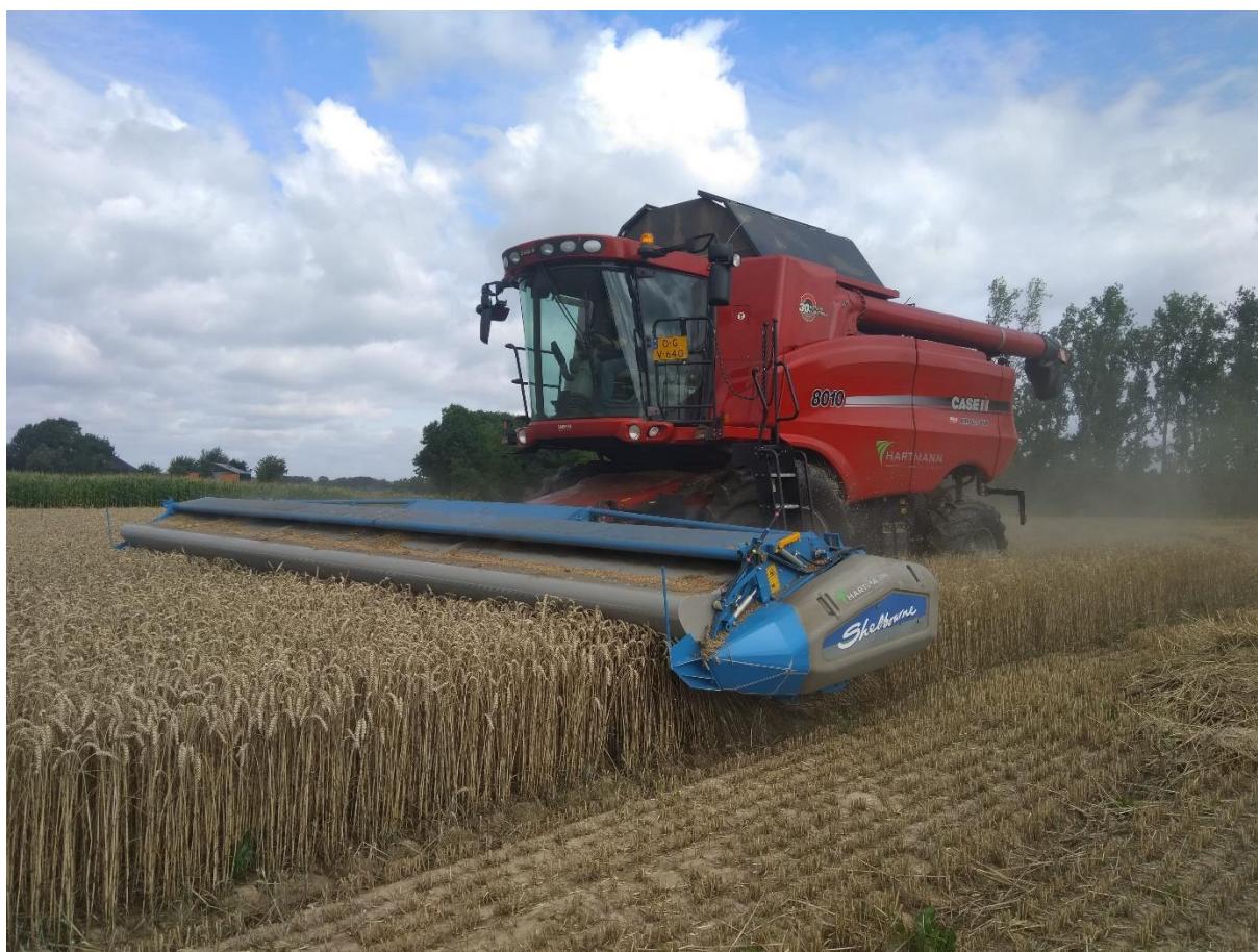
Figuur 19 Arenstripper van loonbedrijf Hartmann in actie op het proefperceel van vzw PIBO-Campus.
