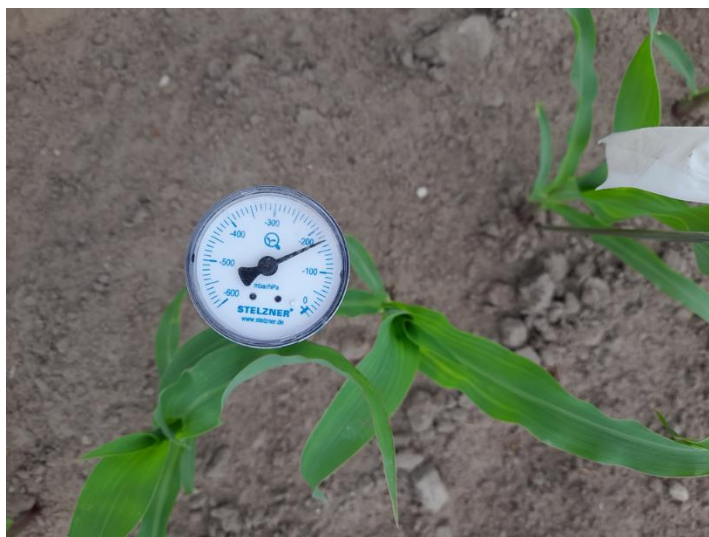
Figuur 2 Tensiometer voor het meten van de zuigspanning van de bodem.
