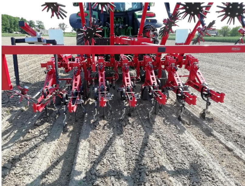
Figuur 17. Schoffelbeurt op 5 juni 2023. Doordat de cichorei op dat moment nog klein was en de GPS soms afwijkingen vertoonde, werd er op maximale afstand van het gewas geschoffeld (7cm).
