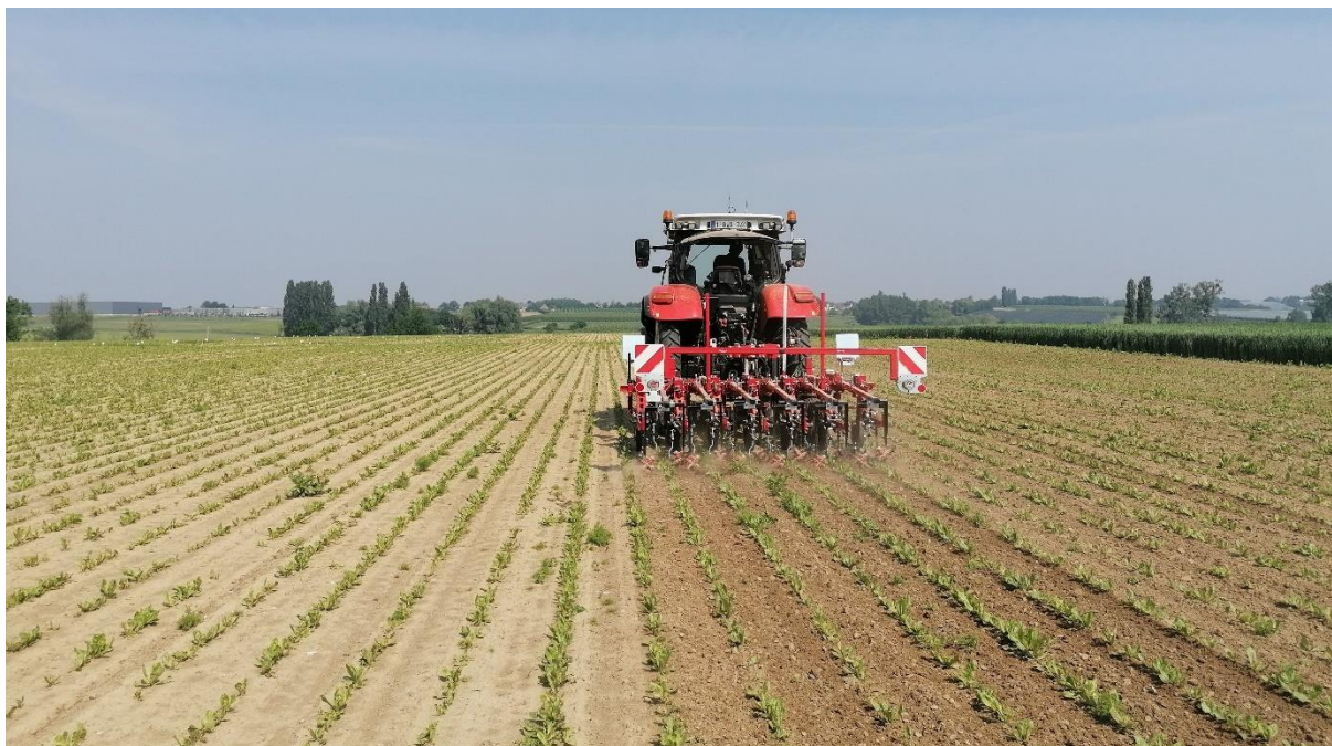
Figuur 16. Stekete camera gestuurde schoffel met kantmessen en vingerwieders.
