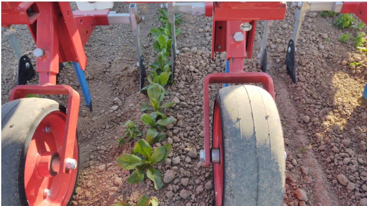
Figuur 9. Gebruik van de frontschoffel uitgerust met kantmessen, 28 mei 2020.
