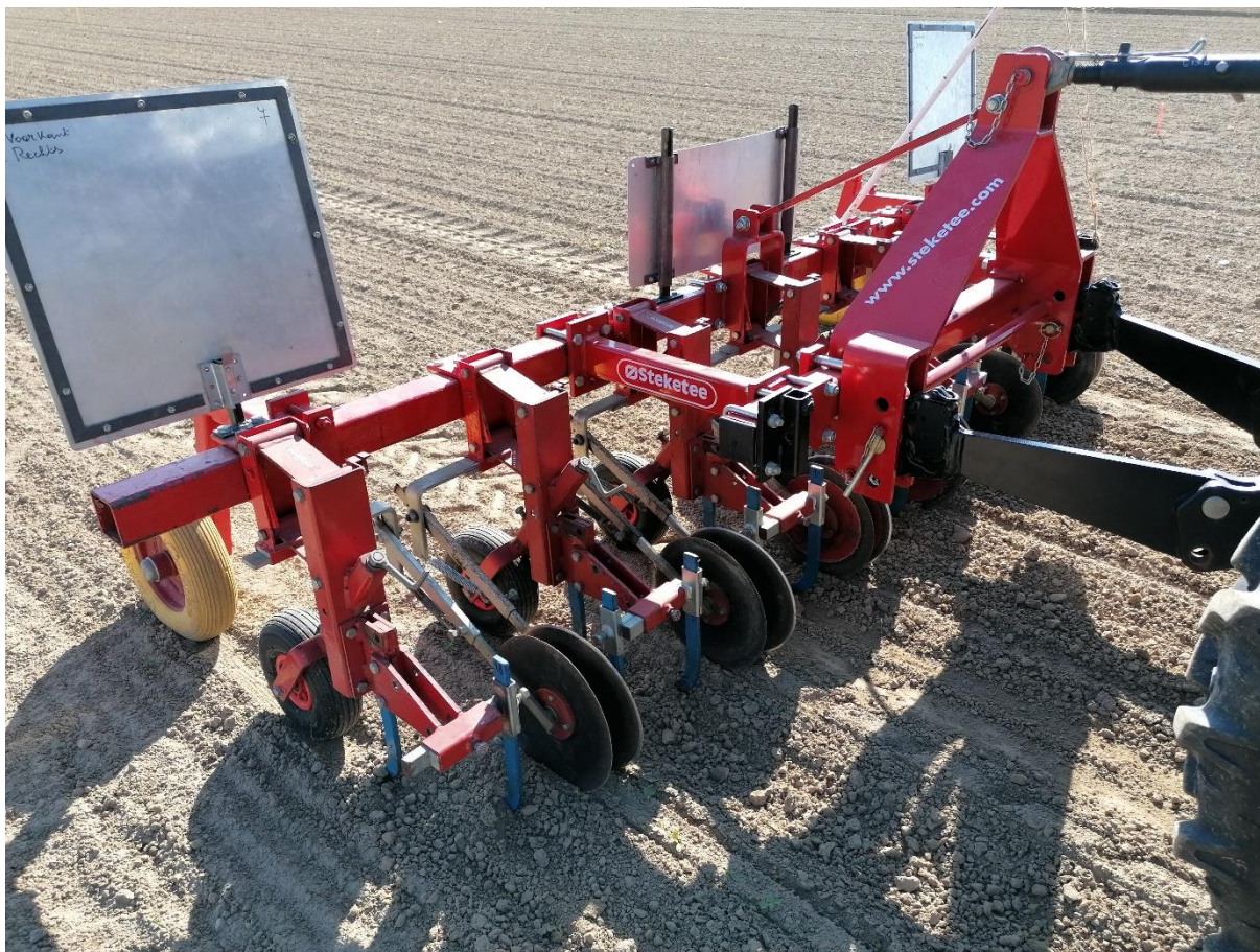
Figuur 7. Eerste mechanische onkruidbestrijding, 7 mei 2020. Frontschoffel uitgerust met gewasbeschermingsschijven om de net bovengekomen cichorei niet te bedekken met aarde. De rijnsnelheid bedroeg 4 km/u.
