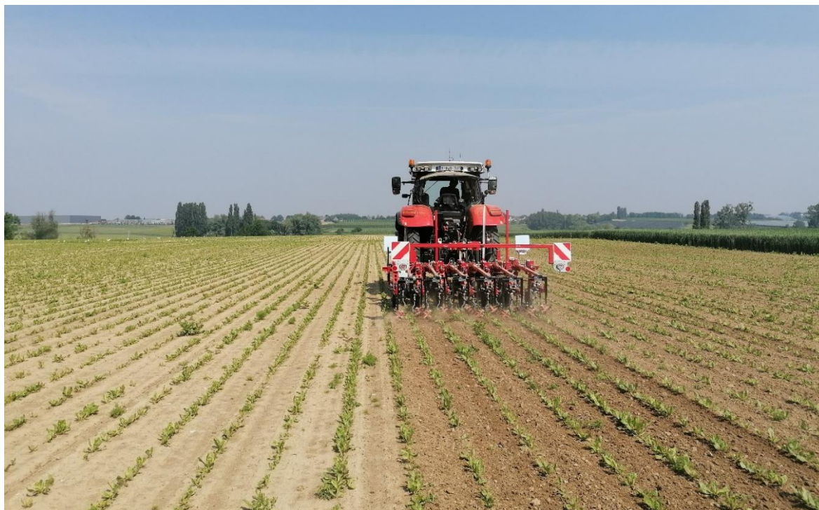
Figuur 19. Steketee cameragestuurde schoffel met kantmessen en vingerwieders. Foto 9 juni 2021.
