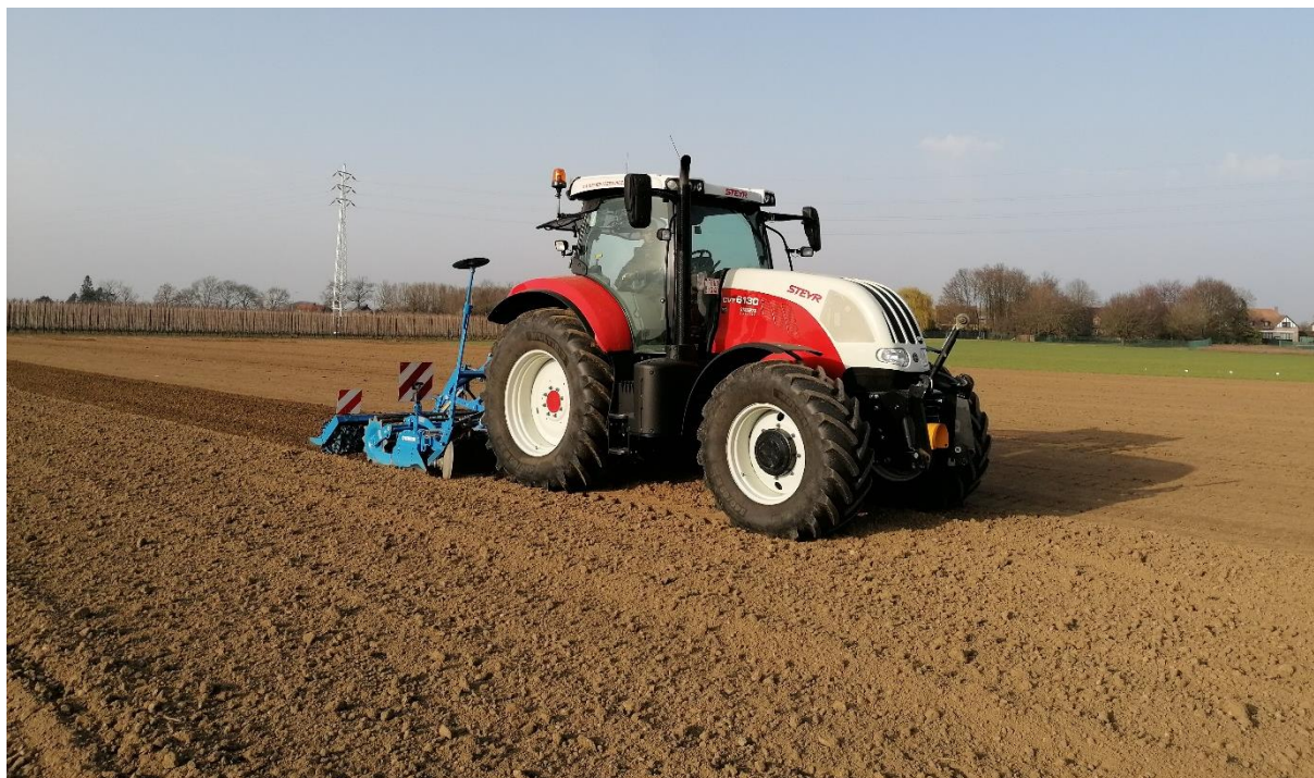
Figuur 31. Lemken rotoreg + croskilette; aanleg vals zaaibed 3 maart 2021.
