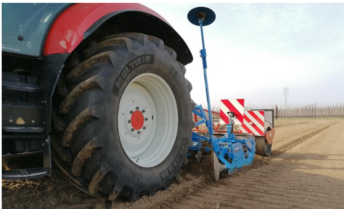
Figuur 32. Lemken rotoreg + vaste rol; aanleg vals zaaibed 3 maart 2021.
