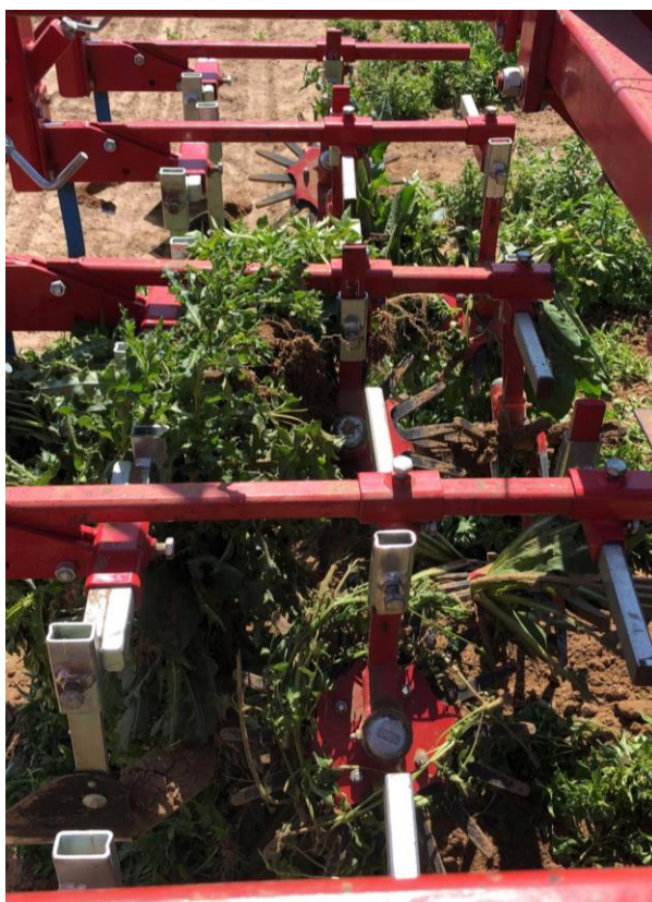
Figuur 25. Opstroppend onkruid in vingerwieders, 23 juni 2020.
