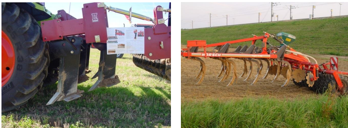
Figuur 3: Voorbeelden van decompactor. Best wordt gekozen voor veel tanden met smalle beitels.
